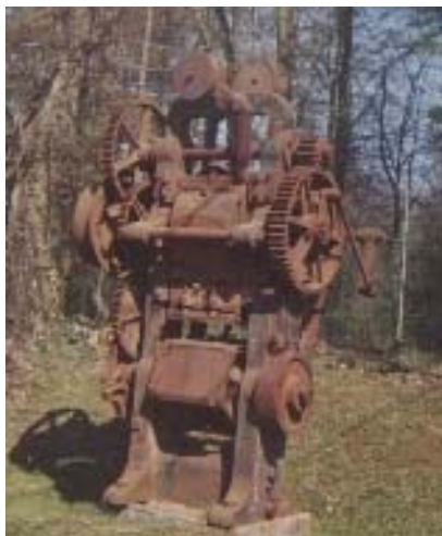
Machine à mouler les tuiles provenant des ateliers Gilardoni
