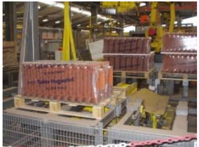
Robot pour charger les colis de tuiles sur les palettes
